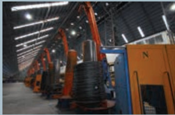
เครื่องรีดหลอดลดขนาด WIRE DRAWING MACHINE
