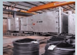
เตาอบหลอด ANNEALING FURNACE
