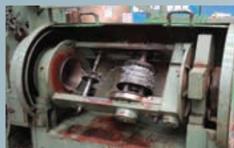
เครื่องผลิตหลอดหนาม BARBED WIRE MACHINE
