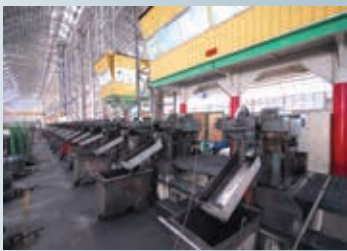
เครื่องผลิตตะปู NAIL MAKING MACHINE
