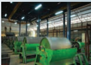
เครื่องขัดตะปู NAIL POLISHING MACHINE
