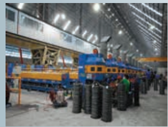
เครื่องรีดหลอดลดขนาดลำดับที่ 2 SECONDARY WIRE DRAWING MACHINE
